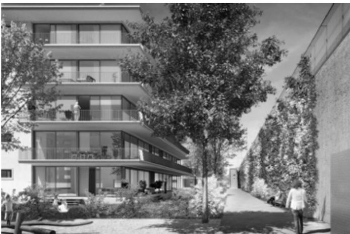
Mauer statt Autobahn: Die Einhausung besteht aus hohen Mauern auf beiden Seiten der Autobahn in Schwamendingen, Mauern, die durch eine Art Dach, den «Deckel» mit einander verbunden sind. Auf dem Deckel wird ein Weg entstehen, und er wird bepflanzt. Wie das Planungsbild zeigt, wird die Mauer mitsamt der Bepflanzung etwa bis auf die Höhe des 4. Stocks der angrenzenden Wohnbauten reichen.
